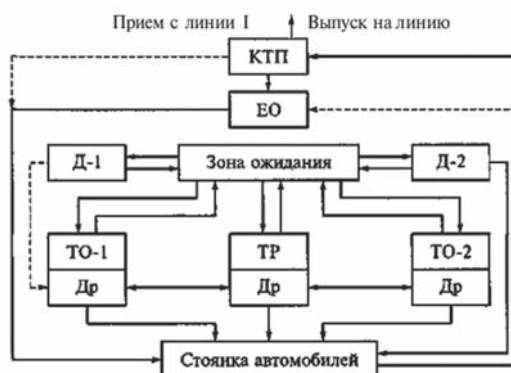
Рис. 1. Функциональная схема ТОиР предприятия
